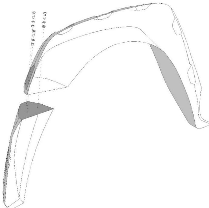
2. Подрез торца бампера спереди и сзади.
